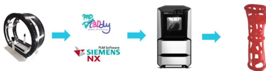
Fig. 1. Le varie fasi del processo di produzione dell'ortesi, dall'acquisizione alla prototipazione
